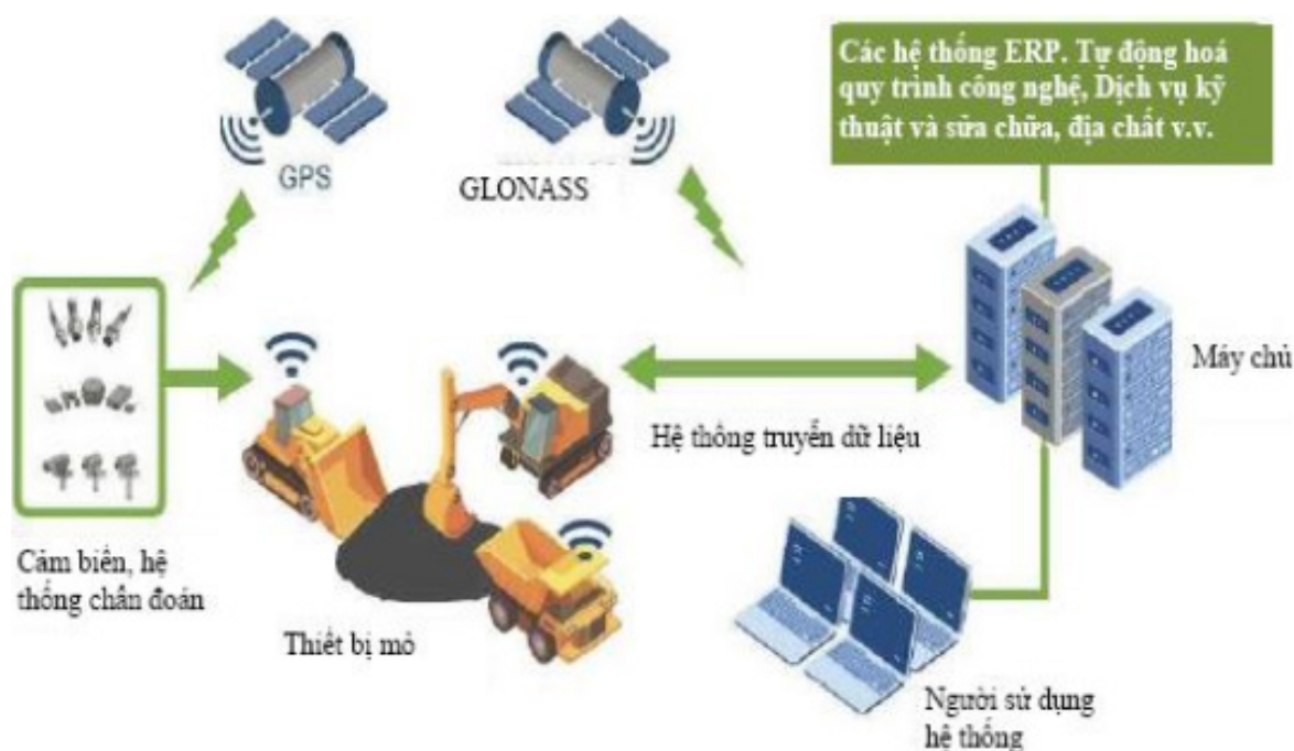
Hình 2. Cấu trúc của ACS GTK "QUARRY"
